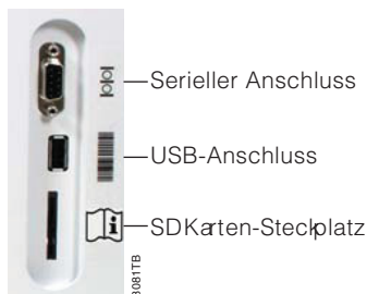
Abbildung 5. Kommunikationsanschlüsse an der Seite des Geräts. Diese Seitenansicht zeigt die Kommunikationsanschlüsse des Geräts. Der USB-Anschluss wird für die Verbindung zum Barcode-Leser verwendet.
